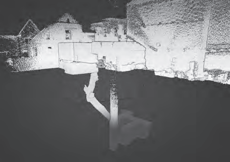
AFBEELDING 4: Kuil Monard in Val-Meer in een 3D model. In de kuil zijn blokvormen zichtbaar, alsook de ontginningschacht met waterput (uitdieping onder de vloer van de groeve). De graet naar de groeve is duidelijk zichtbaar met enkele doodlopende nisjes en begint in een gewelfde mergelkelder waarvan de welving tevens goed zichtbaar is.
